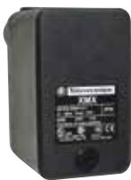
Sécurité manque d'eau conçue pour être montée à l'**aspiration** du surpresseur. Arrête la pompe automatiquement lorsqu'elle se trouve en sous-pression. **Redémarrage automatique, dès le retour de la pression dans le réseau d'alimentation.** Montage inclus.
