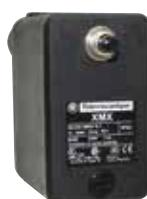
Sécurité manque d'eau conçue pour être montée au **refoulement** du surpresseur. Arrête la pompe automatiquement lorsqu'elle se trouve en sous-pression. **Réarmement manuel.** Montage inclus.
