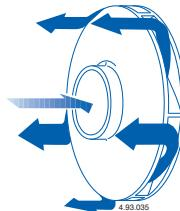
Diffuseur à flux longitudinal-péphérique, pour un autoamorçage plus rapide.
