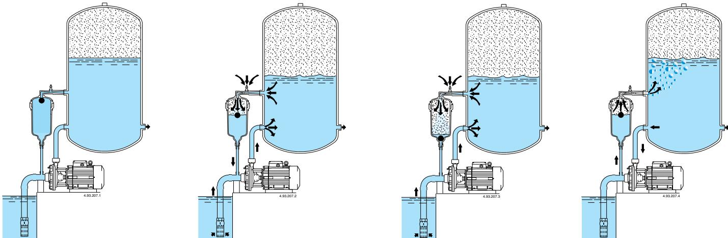
1) Lorsque la pompe est à l'arrêt, le réservoir de l'ARIAMAT est plein d'eau.
