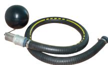
Système permettant d'aspirer l'eau d'un puits ou d'une réserve sous la surface, entre deux eaux, sans aspirer les impuretés flottantes et les eaux chargées au fond de l'installation. Ensemble composé de 2 raccords + 2 colliers inox + tuyau **TAN**. Longueur 1.50 m + crêpine + boule PVC flottante.
