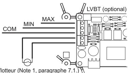
Interrupteur à flotteur (Note 1, paragraphe 7.1.)
