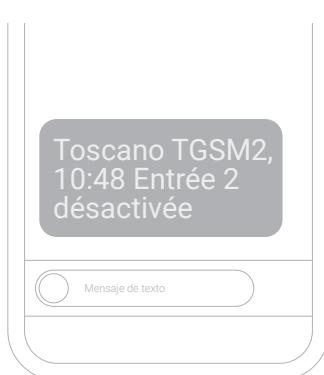
Lorsque l'entrée 1 ou l'entrée 2 passe de l'état actif à l'état inactif, le module TGSM2 envoie un SMS l'indiquant en précisant l'heure de l'événement.
