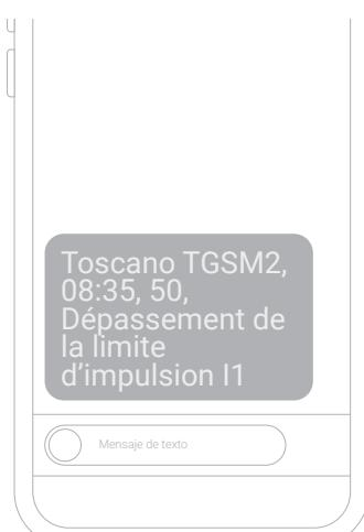
Si l'option du compteur d'impulsions est activée (voir page 19) et que la limite d'impulsions établie est dépassée, le module TGSM2 envoie un SMS l'indiquant en précisant l'heure de l'événement.
