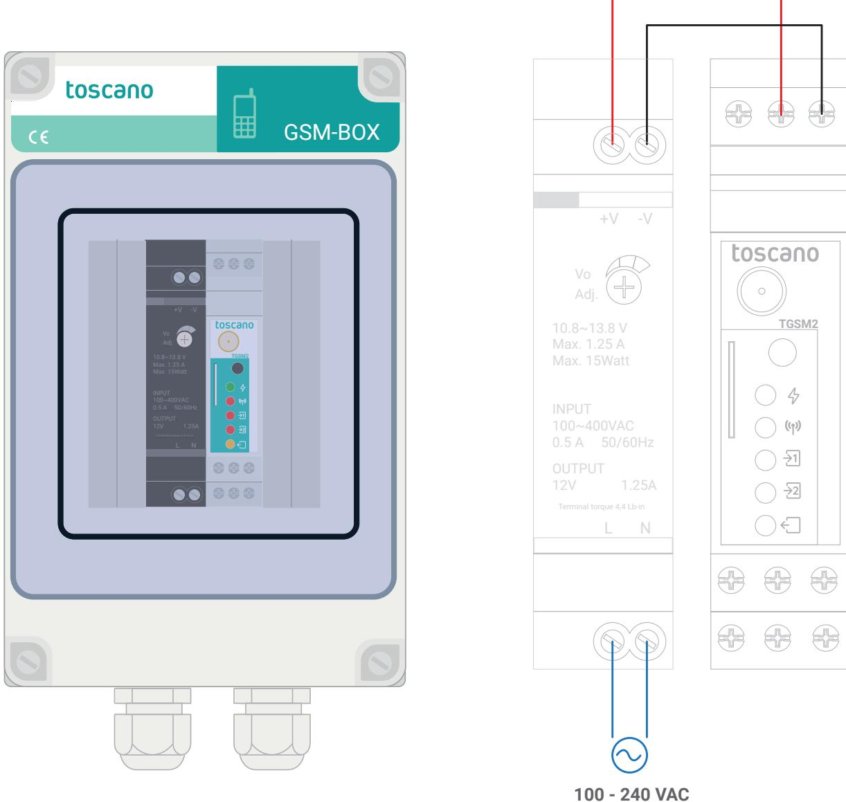
Raccordez le coffret à une alimentation électrique comme indiqué dans le schéma ci-dessus.
