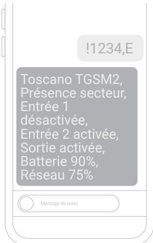
Permet de renvoyer un message avec l'état général du module TGSM2 (état des entrées, de la sortie, de la batterie, de la couverture réseau et de l'alimentation externe).
