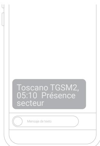
Lorsque l'alimentation électrique est rétablie, le module TGSM2 envoie un SMS l'indiquant en précisant l'heure de l'événement.
