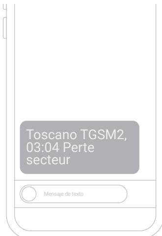
Lorsqu'une coupure de tension se produit sur le module TGSM2, celui-ci envoie un SMS envoi un SMS l'indiquant en précisant l'heure de l'événement.
