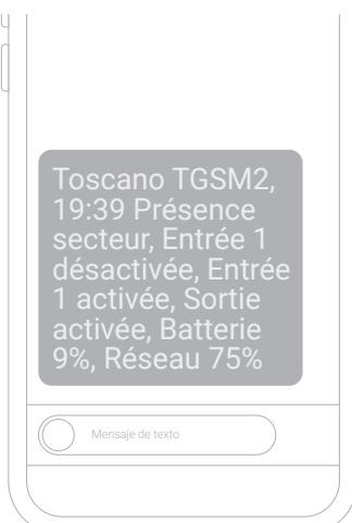
Lorsque la batterie du module TGSM2 tombe en dessous de 10%, le module envoie alors un SMS d'état en précisant l'heure de l'événement.
