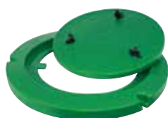
COUVERCLE + ENTRETOISE : KTF Spécial installation sous dalle béton et tampon fonte Ø 800. Ouverture facile du poste grâce à l'entretoise Ø 650 et au couvercle intérieur Ø 500.
