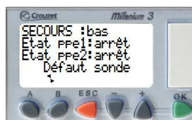
Mode secours 2 poires : poire de niveau bas noyée
