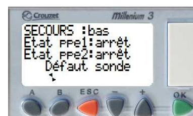
Mode secours 3 poires : poire de niveau bas noyée
