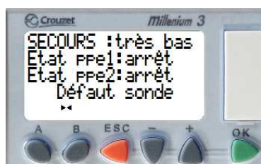
Mode secours 2 poires : aucune poire noyée
